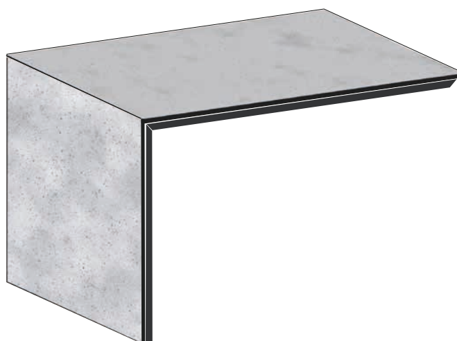
2. Taglio a 45° per montaggio a L*
